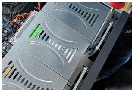
6. Закройте крышку NVR м закрепите ее боковыми винтами.
