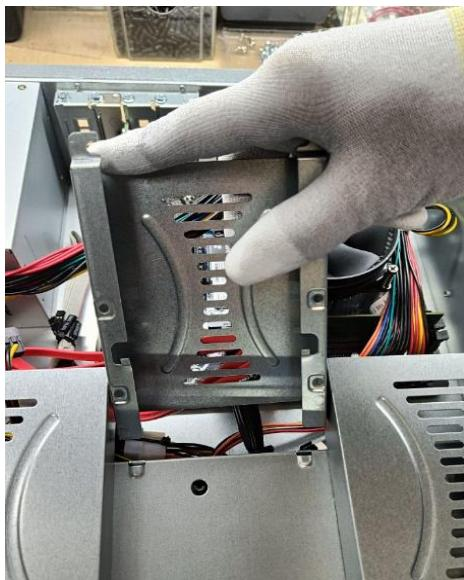
3. Установите жесткий диск в корзину и закрепите его винтами:
